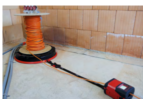
RM35 připevněný k XB 500 popruhem s klipovým systémem
