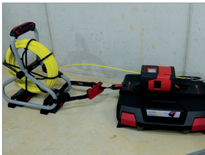
RM35 s montážní deskou na kufru a s protahovacím perem ze skelného vlákna Ø 4,5 mm
