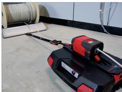
RM35 mit PRO 530 und 5 x 2,5 mm 2 Kabel
