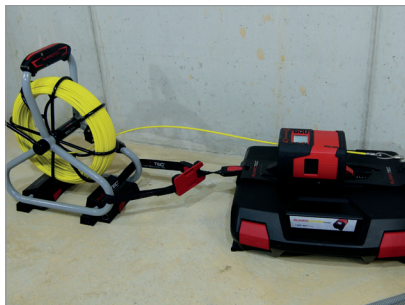
RM35 mit Montageplatte-Koffer, Glasfasereinziehsystem Ø 4,5 mm
