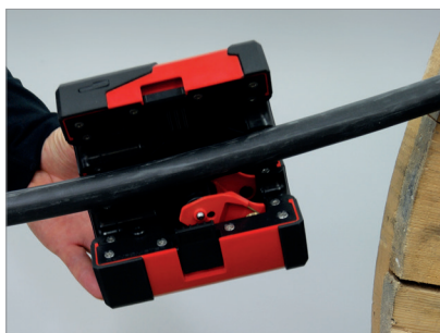
RM35 klappbar mit 5 x 16 mm 2 Erdkabel
