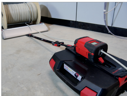
RM35 s PRO 530 a kabelem 5 x 2,5 mm 2
